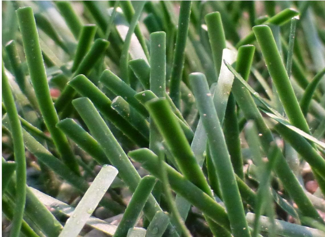
Fieldturf BiCo Faser (Core) nach 200 000 Doppelhübe im Lisport (Simulation 15 Jahre extreme Belastung / oder 20 Jahre mittlere Belastung)
